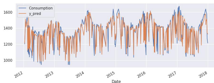
Рис. 1. Порівняння даних споживання електроенергії та прогнозу на основі LGBM
